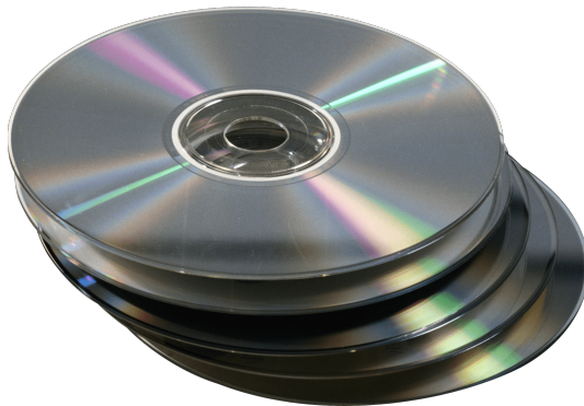
Abbildung 1.4: CDs kamen 1982 auf den Markt. Sie funktioniert durch das “einbrennen” von Punkten und Strichen, die die Daten repräsentieren. Gelesen werden diese wiederum durch die Reflektion eines Lasers an diesen Punkten und Strichen.
