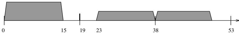
Abb. 4.7 Frequenzen des Hauptteils des Stereo-Multiplexsignals in kHz. Summensignal mit Frequenzen \leq 15 kHz, Seitenbänder mit Frequenzen oberhalb 23 kHz; Pilotton mit 19 kHz. Die RSB-Seitenbänder bei 57 kHz sind nicht im Bild
