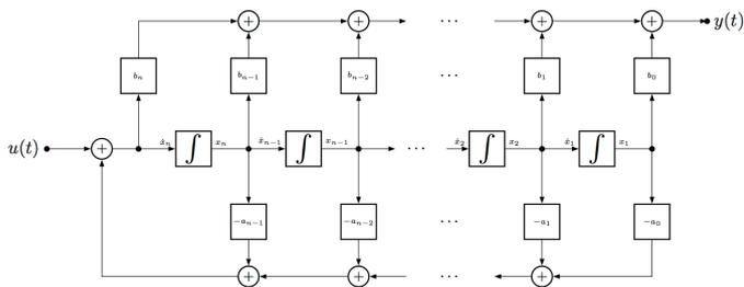
$$\begin{bmatrix} \dot{x}_1(t) \\ \dot{x}_2(t) \\ \vdots \\ \dot{x}_{n-1}(t) \\ \dot{x}_n(t) \end{bmatrix} = \begin{bmatrix} 0 & 1 & 0 & \dots & 0 \\ 0 & 0 & 1 & \dots & 0 \\ \vdots & \vdots & \vdots & \ddots & \vdots \\ 0 & 0 & 0 & \dots & 1 \\ -a_0 & -a_1 & -a_2 & \dots & -a_{n-1} \end{bmatrix} \cdot \begin{bmatrix} x_1(t) \\ x_2(t) \\ \vdots \\ x_{n-1}(t) \\ x_n(t) \end{bmatrix} + \begin{bmatrix} 0 \\ 0 \\ \vdots \\ 0 \\ 1 \end{bmatrix} \cdot u(t),$$
