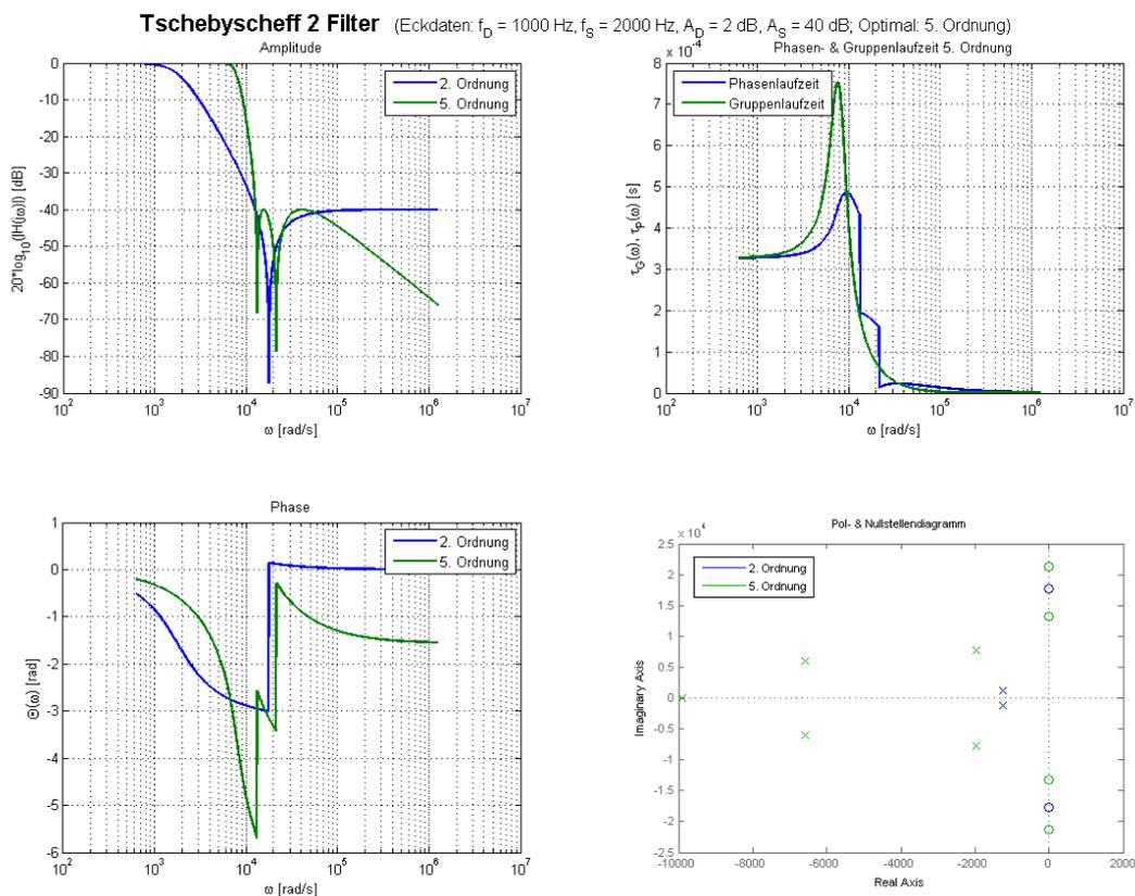
Tschebyscheff-II-Filter mit UTF  $H(s) = \frac{628.3s^4 + 1.081e-009s^3 + 3.969e011s^2 + 1.975s + 5.014e019}{s^5 + 2.701e004s^4 + 3.645e008s^3 + 3.076e012s^2 + 1.639e016s + 5.014e019}$
