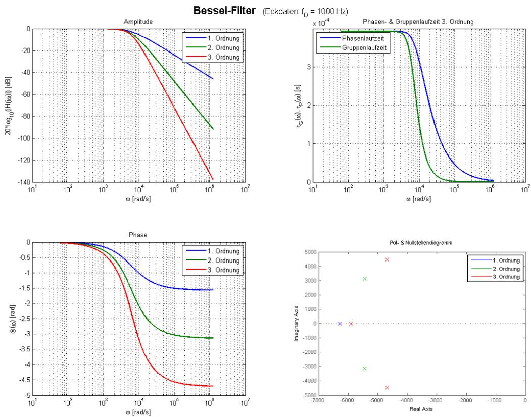
Bessel-Filter mit UTF  $H(s) = \frac{2.481e011}{s^3 + 1.529e004s^2 + 9.736e007s + 2.481e011}$
