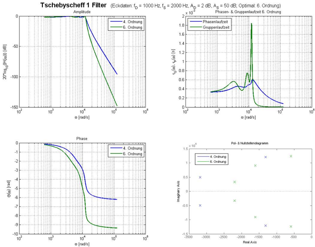
Tschebyscheff-I-Filter mit UTF  $H(s) = \frac{1.609e023}{s^6 + 8812s^5 + 2.757e008s^4 + 1.721e012s^3 + 1.924e016s^2 + 6.589e019s + 2.026e023}$
