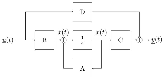
$$\dot{\underline{x}}(t) = \underline{A}\underline{x}(t) + \underline{B}\underline{u}(t) \quad (\text{Zustandsgleichung})$$
