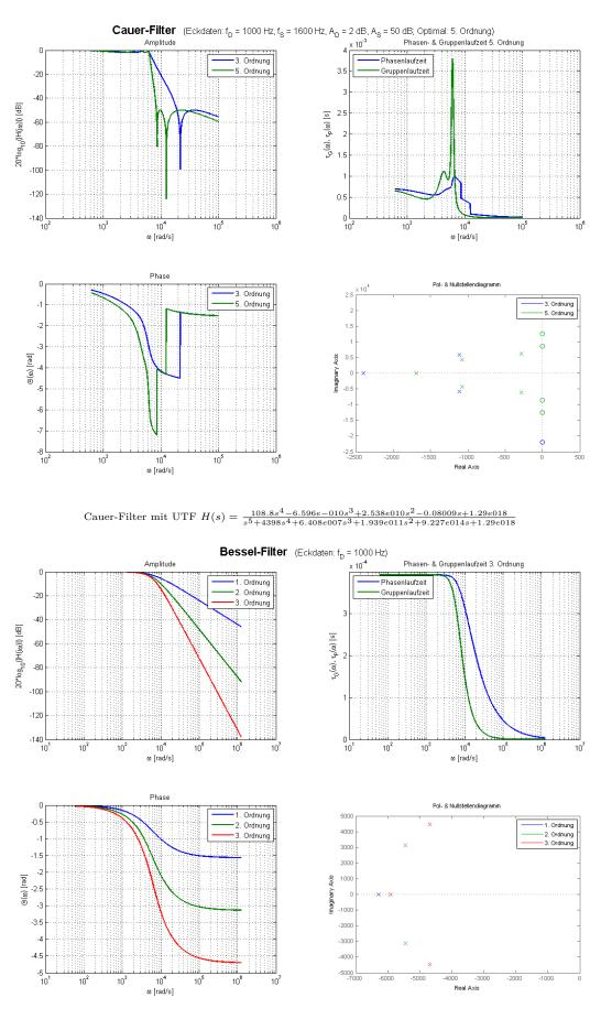
Bessel-Filter mit UTF  $H(s) = \frac{2.481e011}{s^3 + 1.529e004s^2 + 9.736e007s + 2.481e011}$
