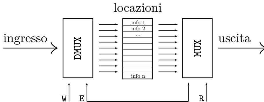
Quando viene richiesta un'operazione di lettura con il segnale **R**, l'indirizzo comanda il multiplexer per passare sull'uscita il dato contenuto alla locazione richiesta. Nell'operazione di scrittura il segnale **W** abilita la scrittura del dato presente in ingresso nella cella indicata tramite il demultiplexer.
