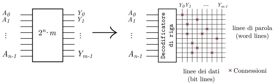
Ogni indirizzo in  $A$  corrisponde una riga che accende i bit sull'uscita  $Y$  in base alle connessioni presenti tra le linee dei dati e le linee delle parole. La connessione può essere costruita con differenti componenti, creando quindi differenti tipi di ROM.
